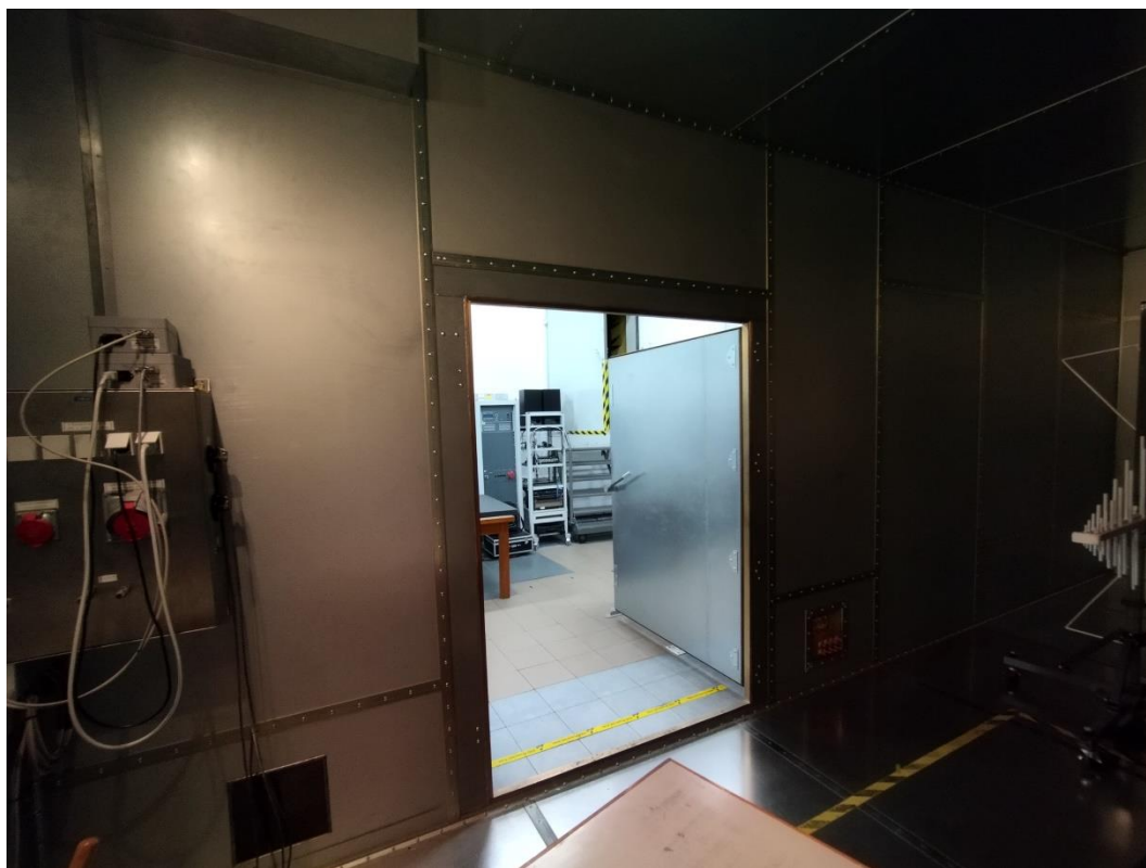
IMG_20211213_090715 Widok na ścianę boczną (od strony drzwi wejściowych) komory rewerberacyjnej
