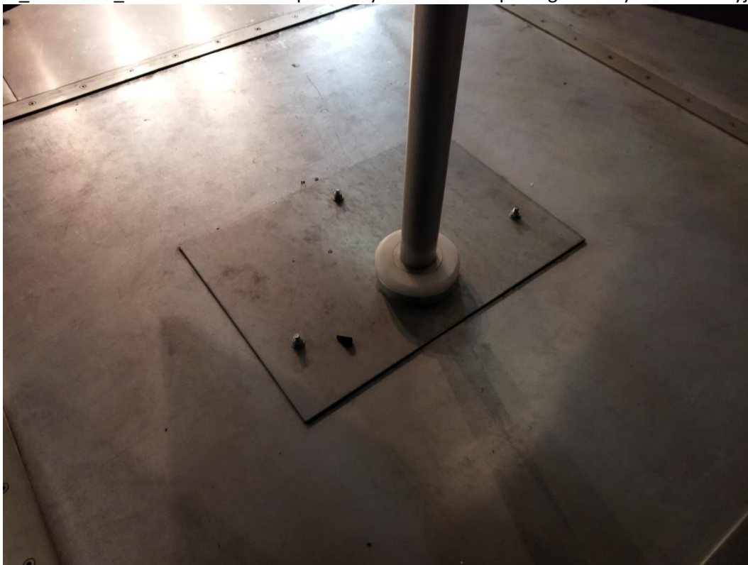
IMG_20211213_090533 Mocowanie podstawy mieszadła do podłogi komory rewerberacyjnej
